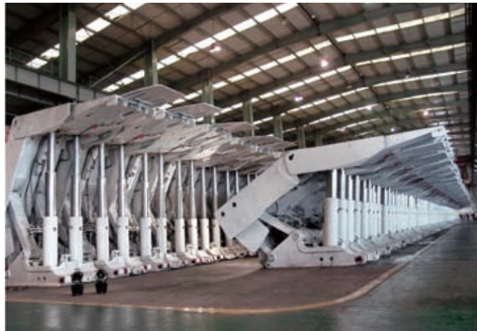
神東煤炭集團與供應商共同研發並投入使用的國產液壓支架
