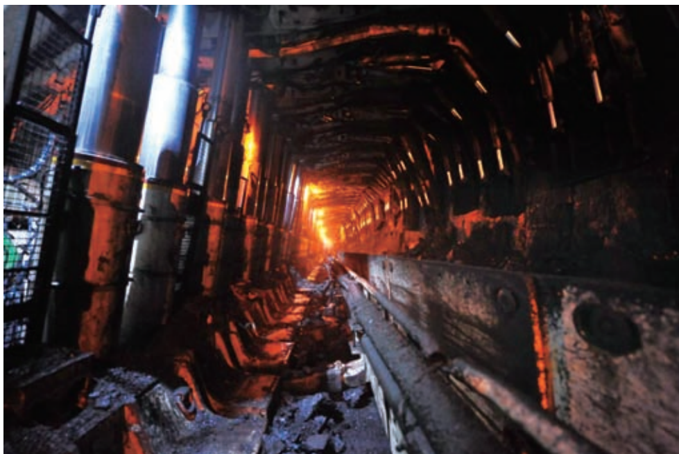
神東補連塔煤礦7米大採高工作面
