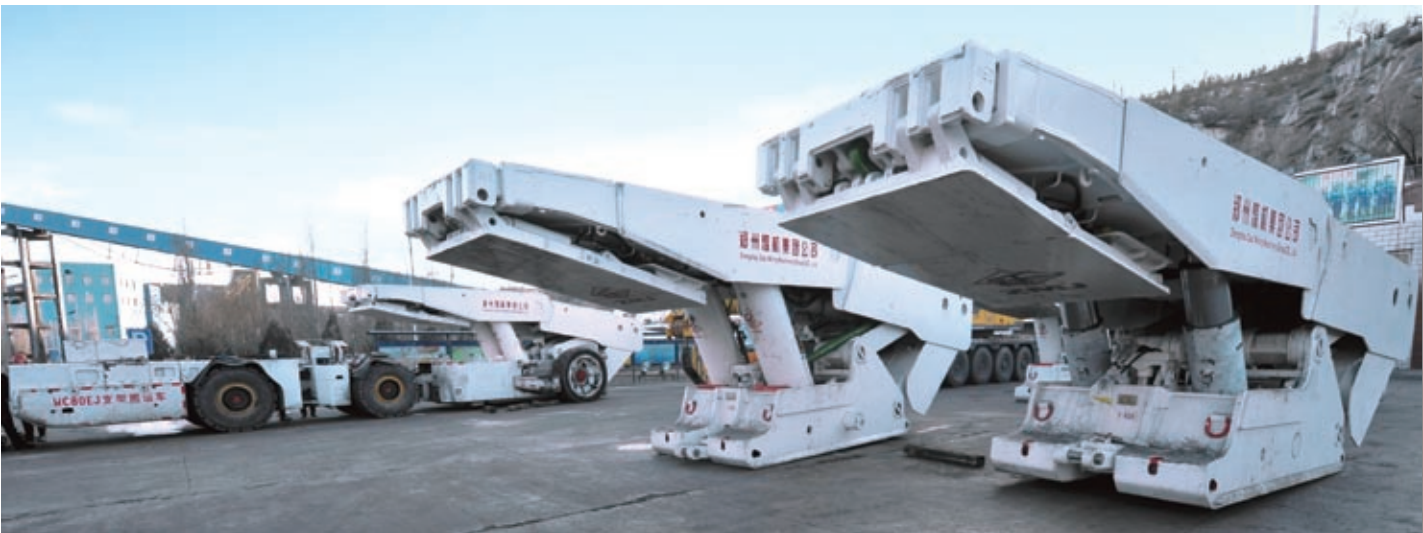
神东矿区应用国产7米液压支架
